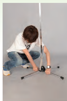
7. 四方脚にぐらつきがないか確認
