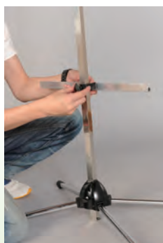
9. 下部受のノブをゆるめ水平にセットする
