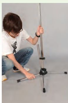
6. バランスよく1脚づつ床に固定する
